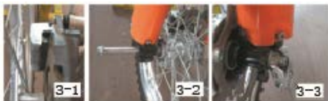
1. Aseta ④ oikean pyörän öljytiiviste (etujarrulevyn laidassa)
